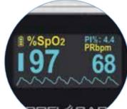
Anzeige von: Sauerstoffsättigung, Herzfrequenz, Perfusionsindex, Pulsweite (Darstellung abhängig von der Display-Ausrichtung)
